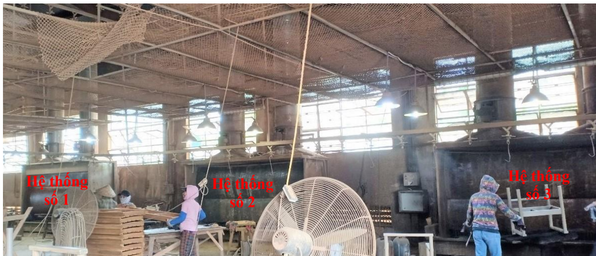
Hình 3.11. Buồng phun sơn màng nước lắp đặt tại nhà máy
