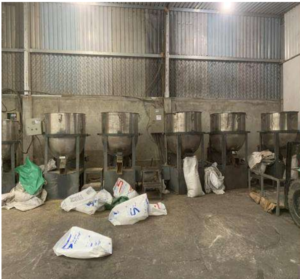
Hình 1.8. Các máy phối trộn hạt nhựa (hình bên trái) và Hệ thống máng làm mát sợi dây nhựa sau khi kéo sợi (hình bên phải)
