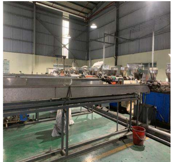
Hình 1.8. Các máy phối trộn hạt nhựa (hình bên trái) và Hệ thống máng làm mát sợi dây nhựa sau khi kéo sợi (hình bên phải)
