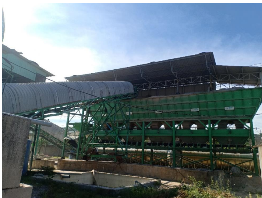
Hình 3.5. Hình ảnh phễu cốt liệu 5 khoang
