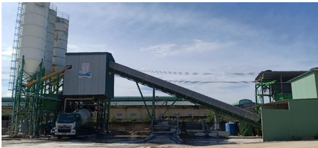
Hình 3.6. Vòm tôn băng tải vận chuyển cốt liệu
