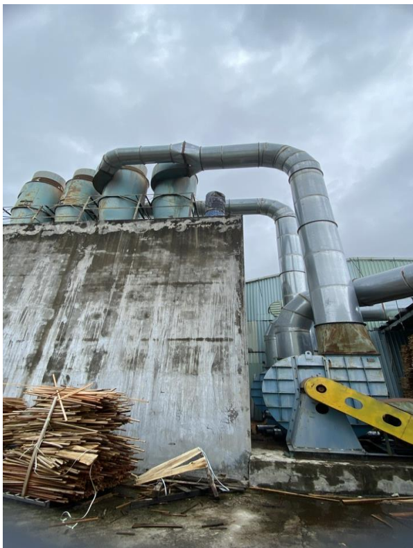
Hình 3.6. Các thiết bị xử lý bụi gỗ từ dây chuyền sản xuất
