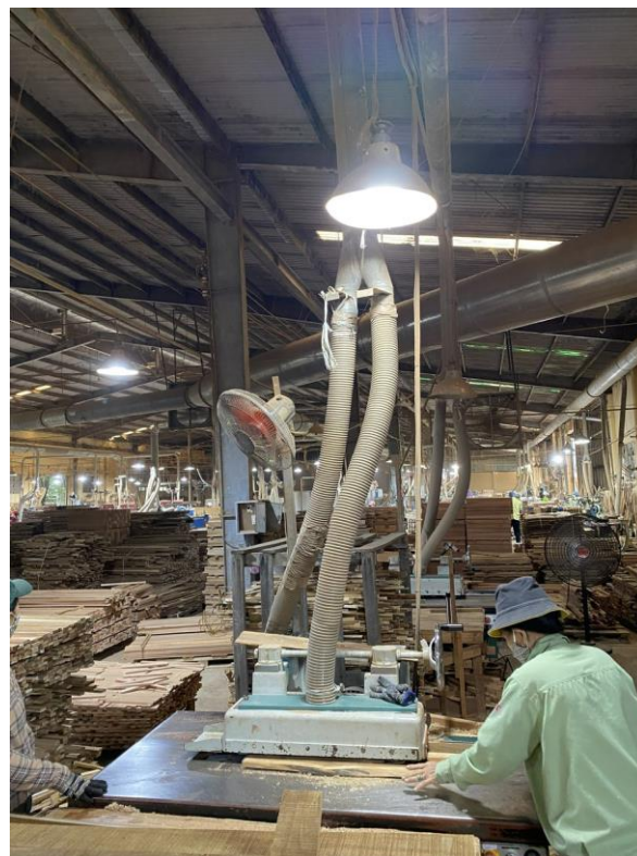
Hình 3.6. Các thiết bị xử lý bụi gỗ từ dây chuyền sản xuất
