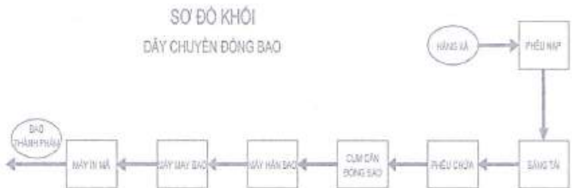
Hình 1. 3. Quy trình công nghệ của dây chuyền đóng bao phân bón
