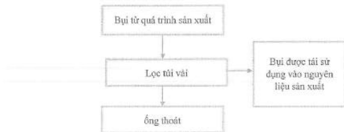
Hình 4. 3. Quy trình xử lý bụi từ quá trình sản xuất
