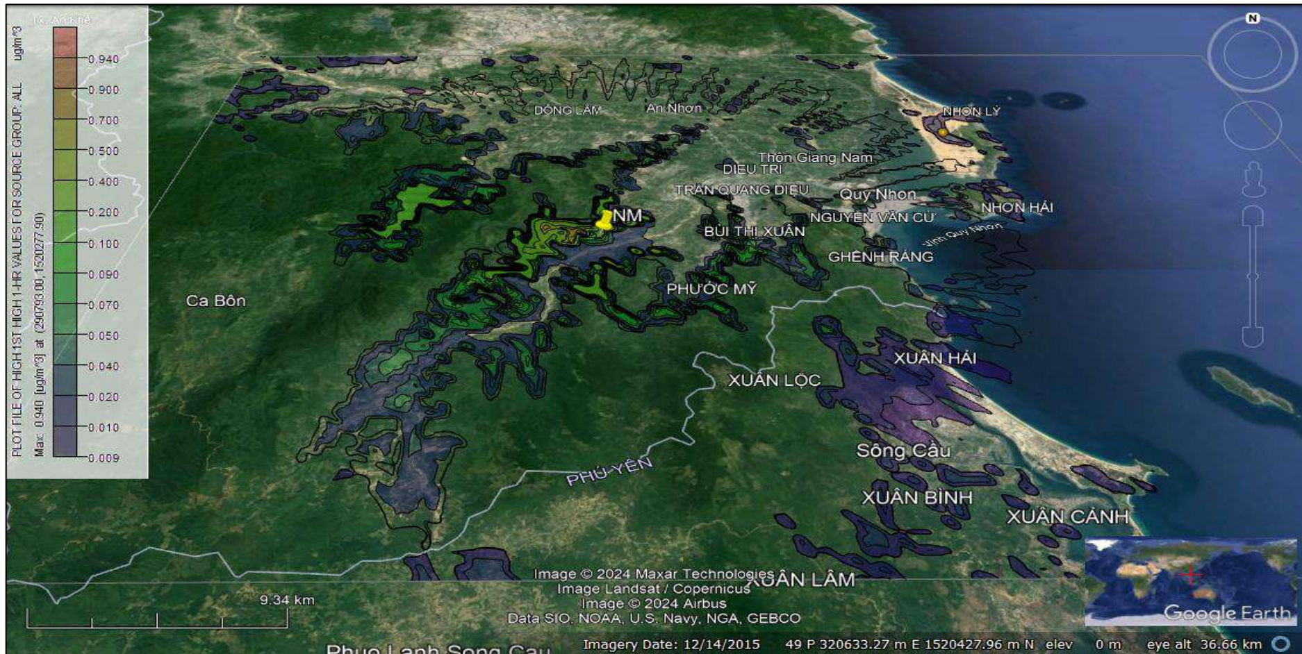
Hình 4. 5. Bản đồ lan truyền \text{SO}_2 trung bình cao nhất 1 giờ trong năm từ mô hình AERMOD. Thang màu bên phải là các mức nồng độ khác nhau
