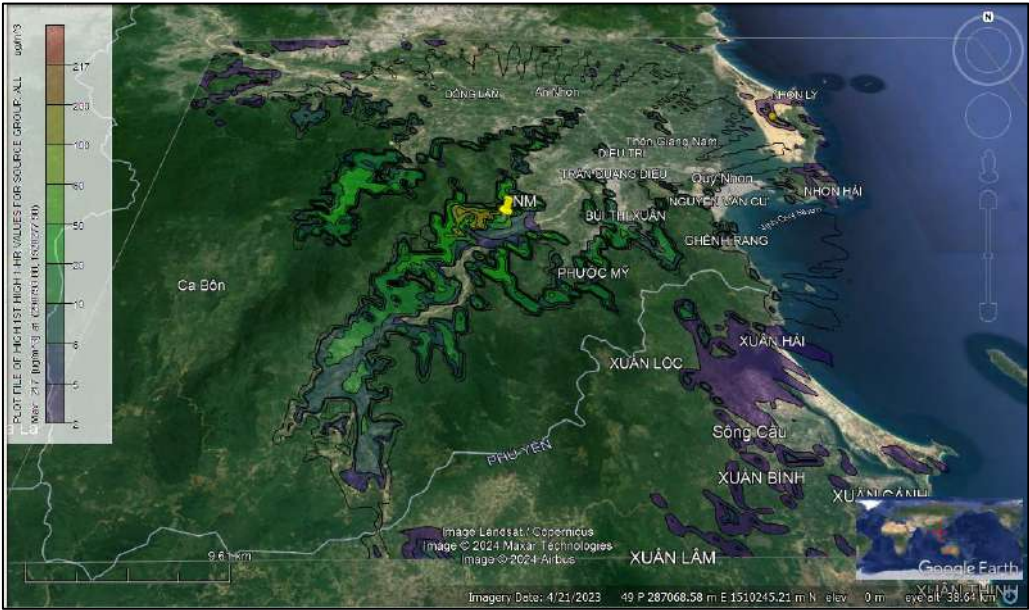
Hình 4. 15. Bản đồ lan truyền NO2 trung bình cao nhất 1 giờ trong năm từ mô hình AERMOD. Thang màu bên trái là các mức nồng độ khác nhau.
