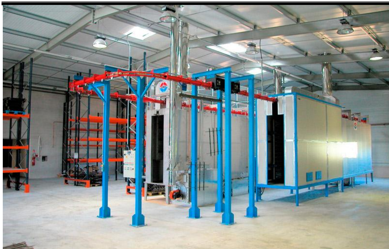
Hình 3.1. Mô phỏng công nghệ phun sơn tĩnh điện dự kiến áp dụng tại nhà máy
