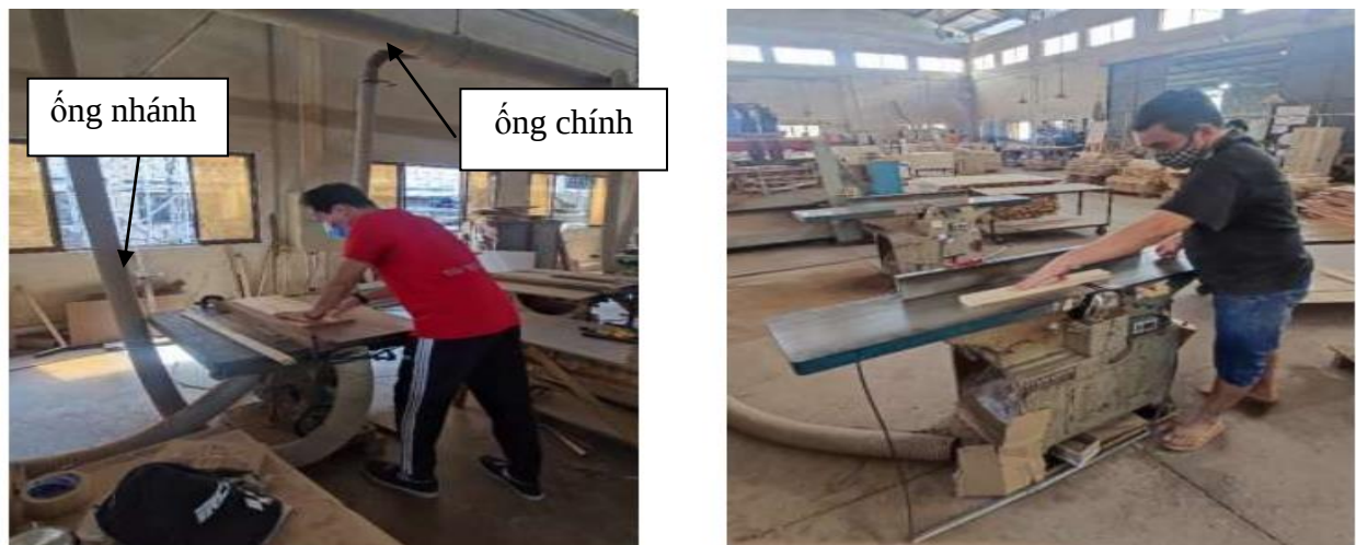
Hình 12. Minh họa thu gom bụi gỗ phát sinh tại máy móc thực hiện cưa, cắt gỗ
