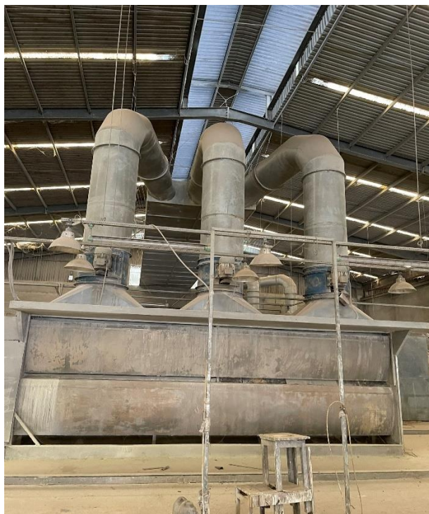
Hình 15. Hình ảnh hệ thống buồng phun sơn màng nước
