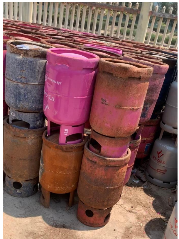
Khu chứa chai LPG không đạt tiêu chuẩn
