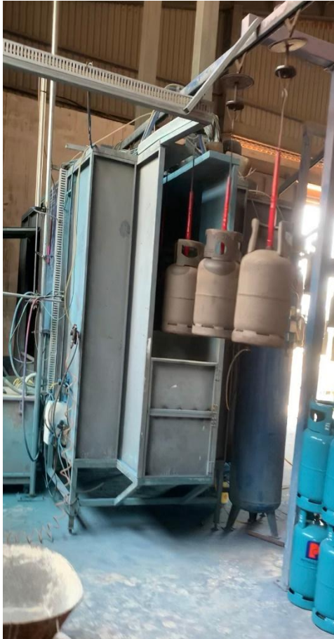
Hình 3.8: Hệ thống xử lý, thu hồi bụi sơn
