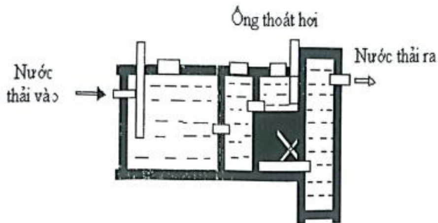
Hình 3.6: Sơ đồ cấu tạo của bể tự hoại ba ngăn
